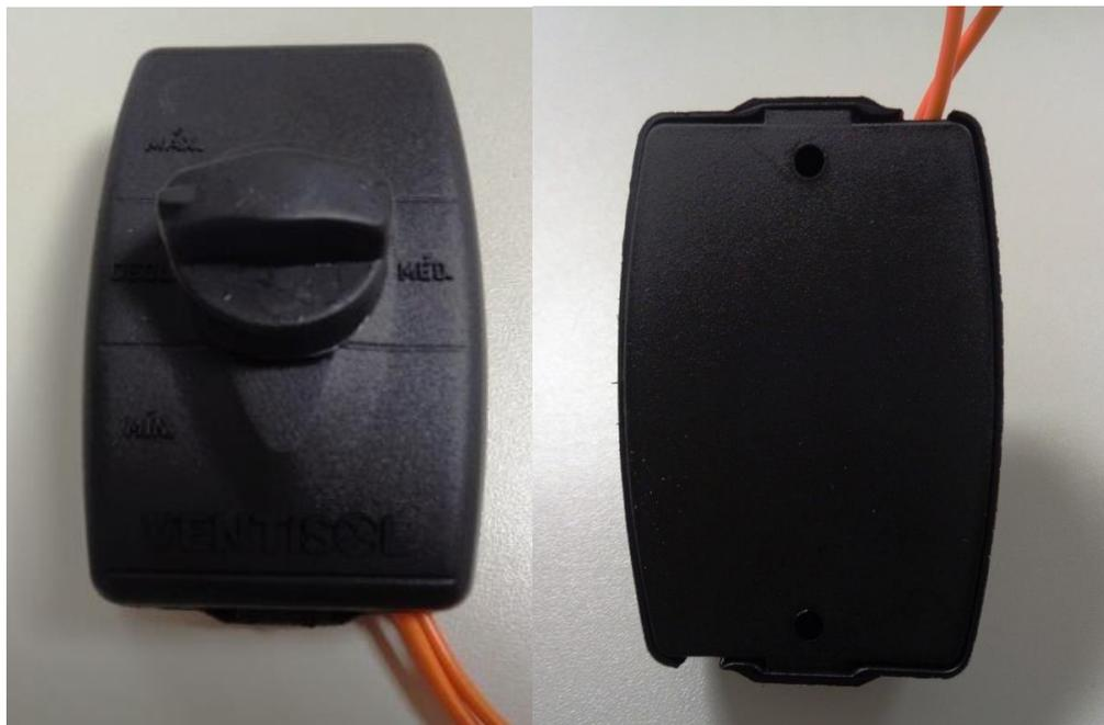
**ATENÇÃO!** O botão do controle de parede deverá ser fixo, não podendo ser removido facilmente. Caso o botão esteja saindo, o fornecedor deverá ser acionado para correção/substituição do produto.
