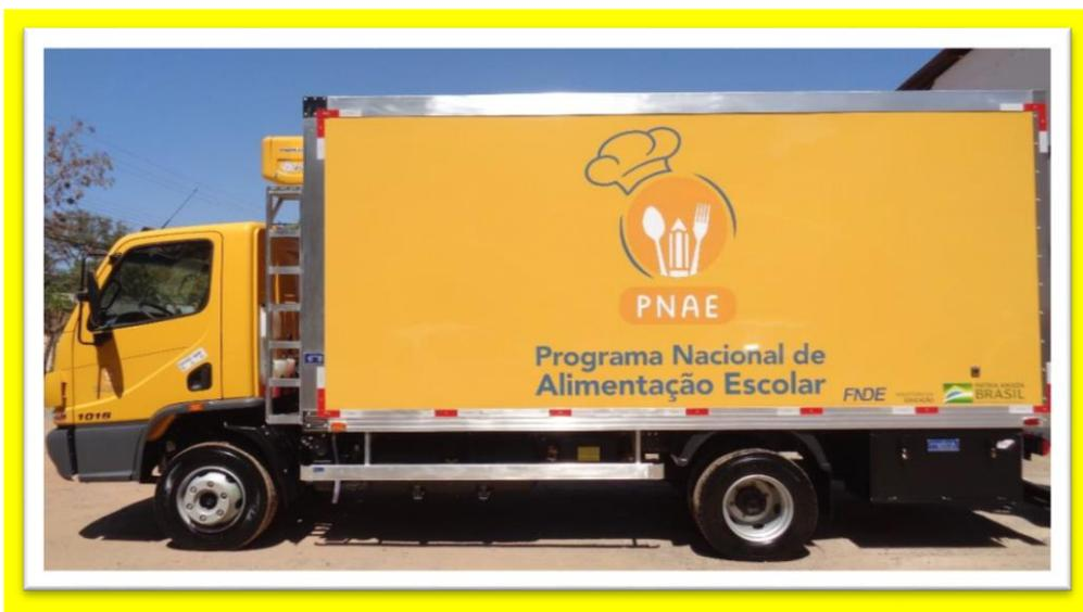
Constituído por um veículo novo, 0 (zero) km do tipo caminhão, da categoria leve, equipado com uma carroçaria rígida, do tipo baú isotérmico misto para refrigeração e congelamento, constituído por características específicas para transporte de produtos alimentícios para o Programa Nacional de Alimentação Escolar – PNAE. Deverá ser movido a combustível Diesel, e possuir condições de operação por meio do uso de Biodiesel, conforme diretrizes do Programa Nacional de Produção e Uso do Biodiesel.
