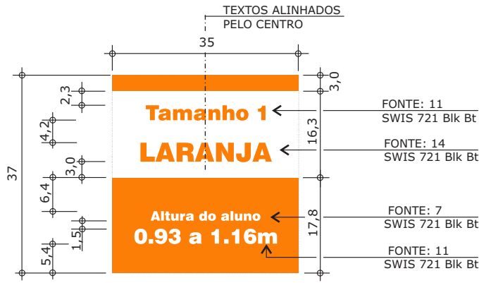
IDENTIFICAÇÃO DO PADRÃO DIMENSIONAL ESC. 1:1
