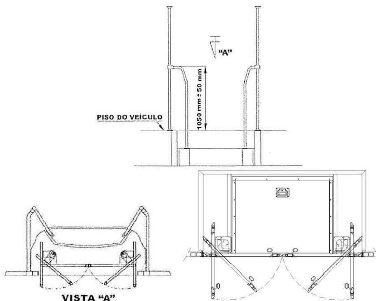
Figura 06 – Imagem ilustrativa: instalação dos corrimãos inferiores
