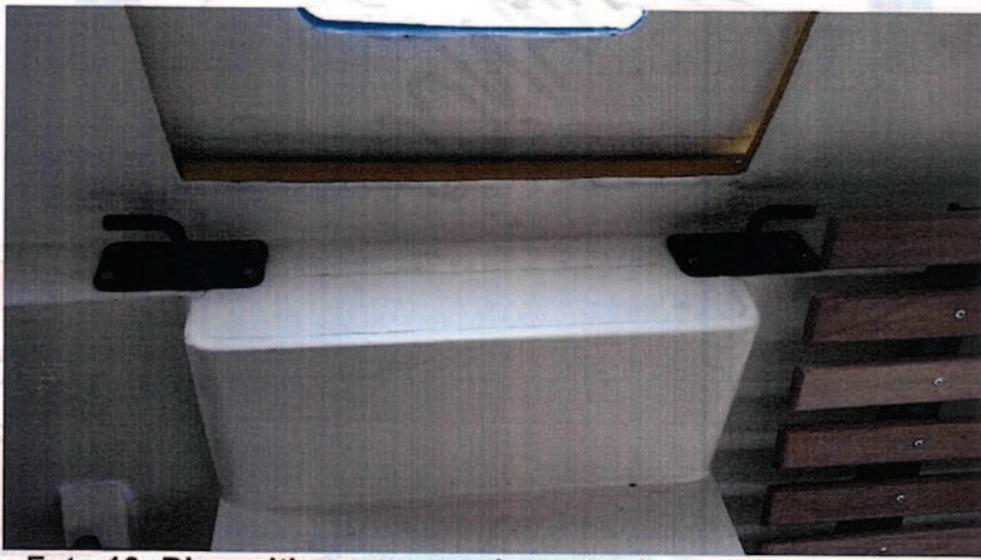
**Foto 10: Dispositivo para acoplamento da escada de resgate.**
