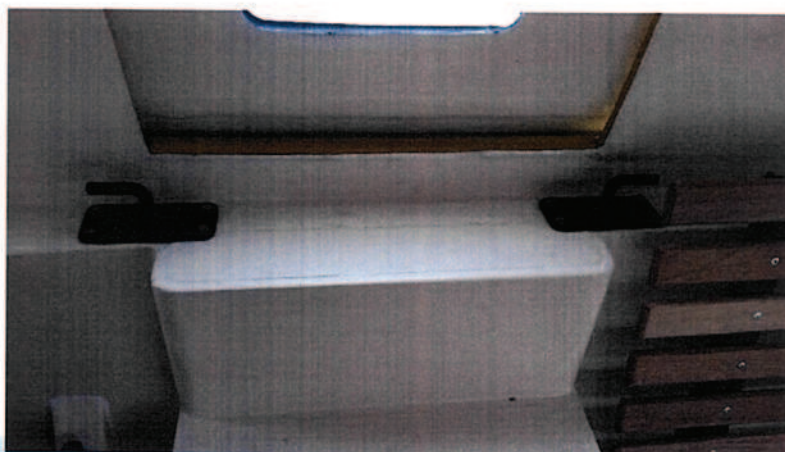
Foto 11: dispositivo para acoplamento da escada de resgate.
