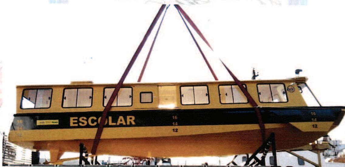
Foto 3: Vista lateral de boreste apresentando defletor de onda de proa e marcas de calado.
