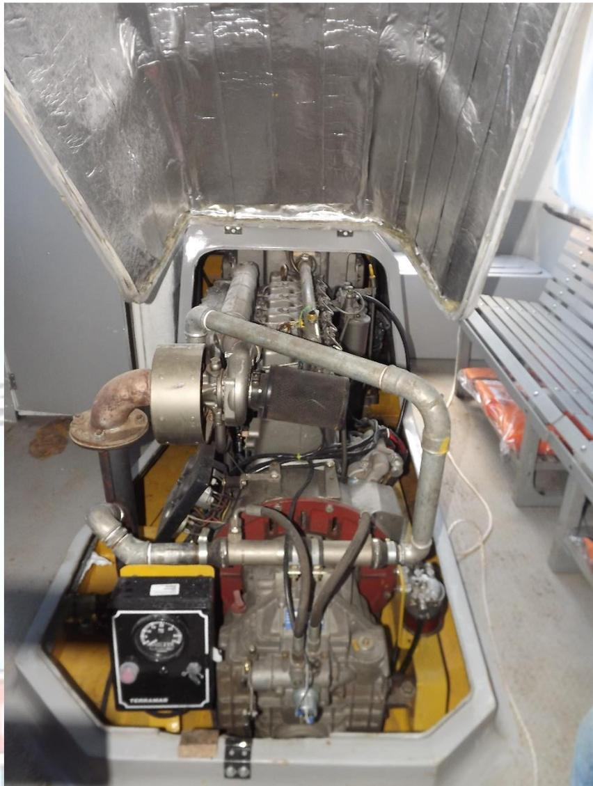
**Foto 10: Motor com proteção termo-acústica e botão de partida.**
