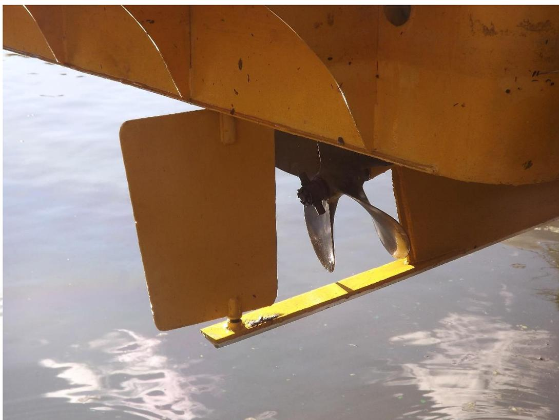
**Foto 11: dispositivo de proteção do hélice.**
