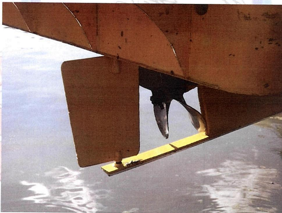
**Foto 10: : dispositivo de proteção do hélice.**
