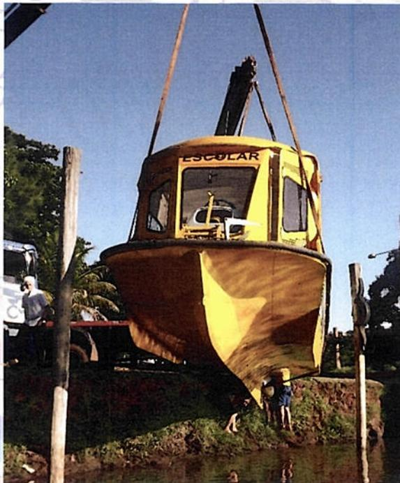
**Foto 3: Perspectiva com vista dos apêndices de proa (defletores de onda de proa).**
