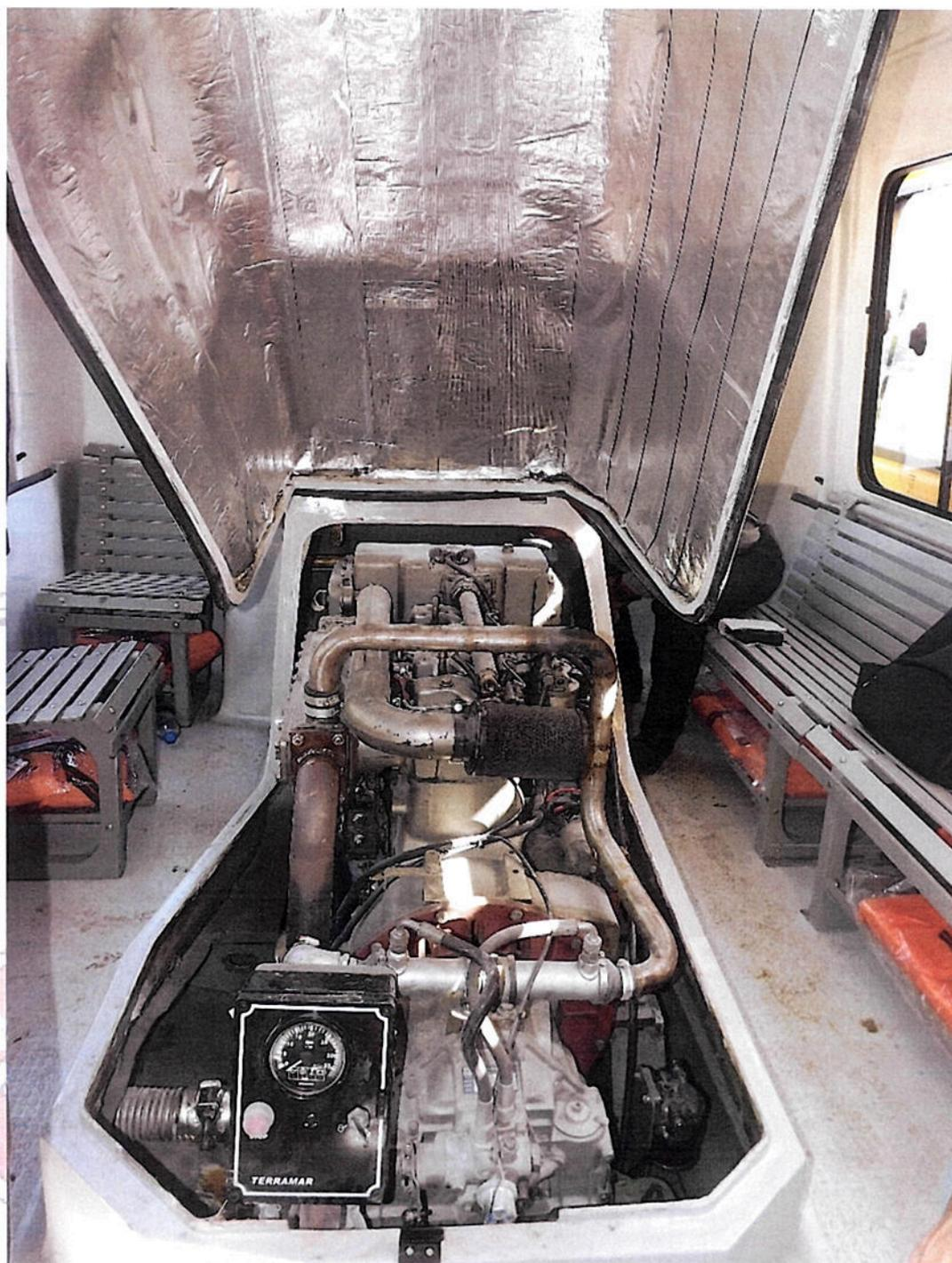
**Foto 6: Motor com enclausuramento termoacústico e botão de partida.**
