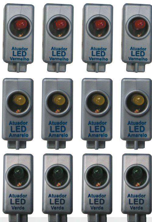
12 lâmpadas (LED) em 3 cores (vermelho, amarelo e verde)
