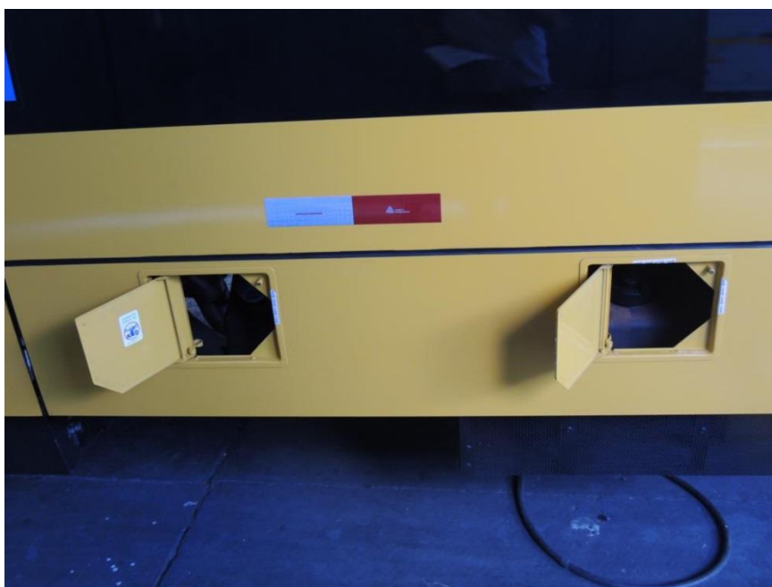
Foto 22: Tampa do tanque do agente redutor de NOx (gás poluente) Arla 32 e de combustível
