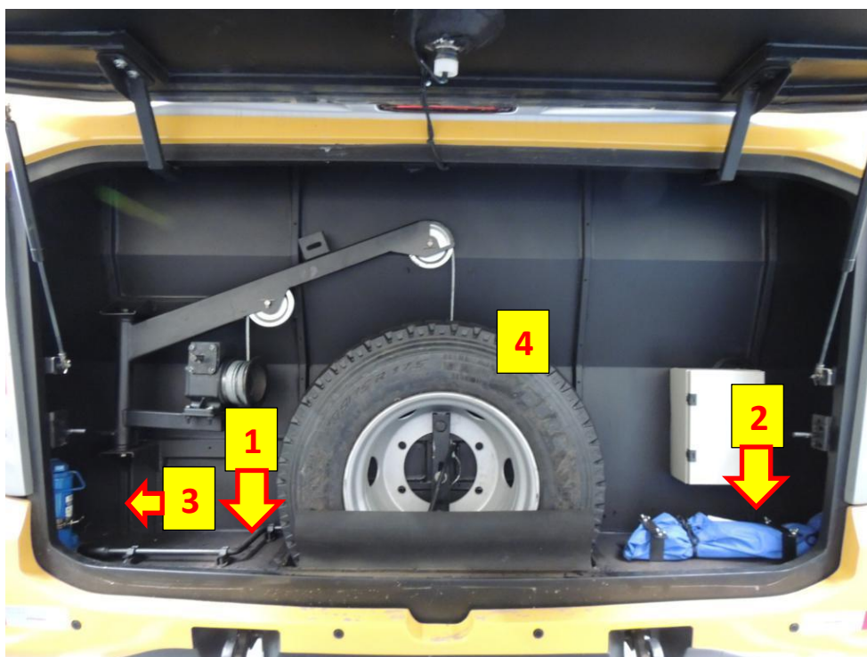
Foto 25: Acomodação dos equipamentos obrigatórios.
