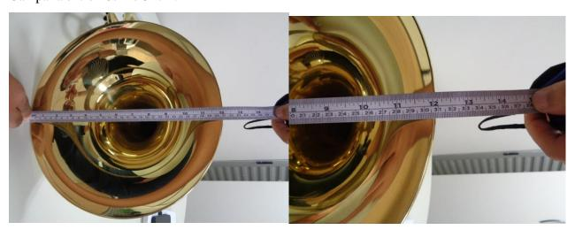
**b)** Calibre interno entre 11,80mm e 12,80mm
