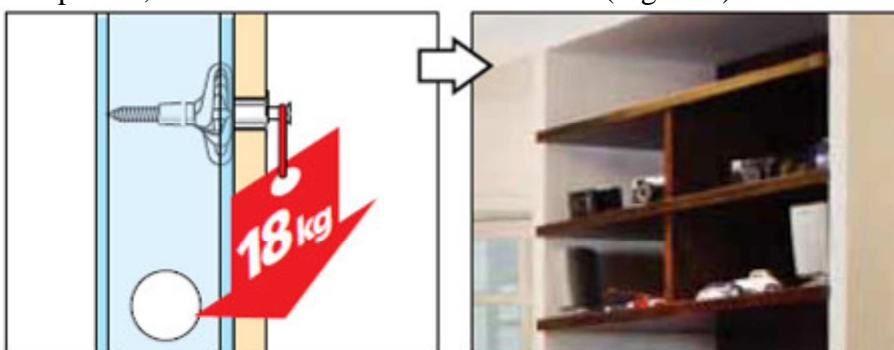
Figura 2 - Fixação de cargas entre 10 kg e 18 kg.
