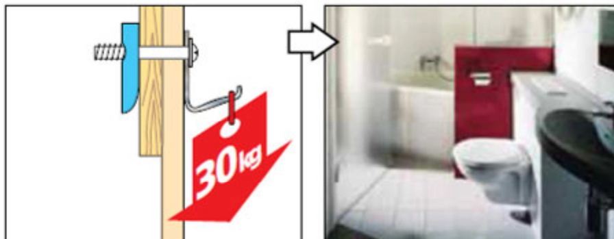
Figura 3 - Fixação de cargas entre 18 kg e 30 kg.
